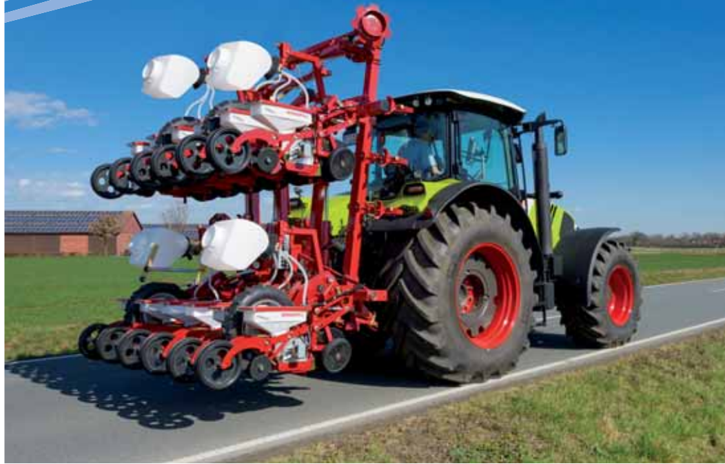
MONOPILL SE, 6 Meter, 12 Reihen parallel-hydraulisch klappbar mit Mikrogranulatstreuer in Transportposition
