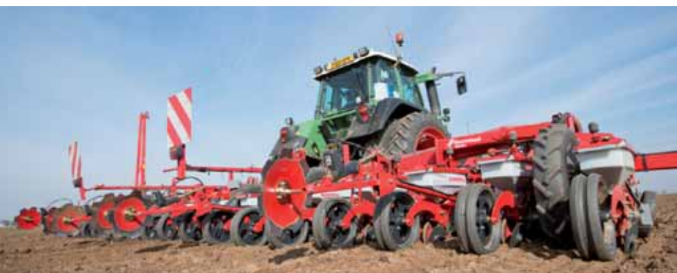
MONOPILL SE, 9 Meter, 18 Reihen mit parallel-hydraulischer Klappung in Arbeitsposition.
