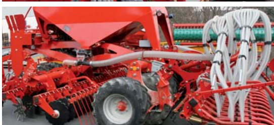
Anordnung der Verteilerköpfe: Düngerausbringung in der Scheibensektion (oben), Düngerausbringung in der Scharschiene (unten)
