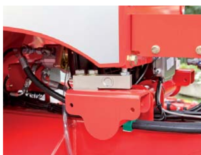
Tankvolumen-Wiegesystem mit separatem Monitor
