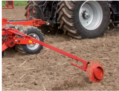
Hydraulisch klappbarer Spuran- reißer mit gezackter Scheibe
