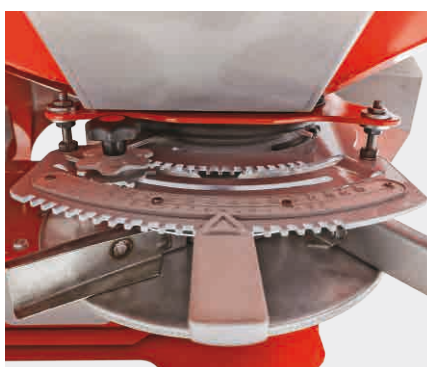
Die Dosiereinrichtung an der Rückseite der Maschine ist einfach zu erreichen und leicht einzustellen.
