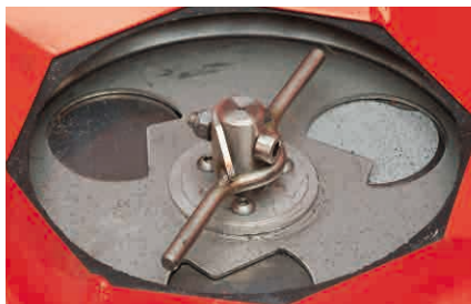
Langsam drehender Rührfinger
