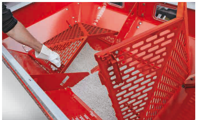
Geöffnetes Sieb in geparkter Position
