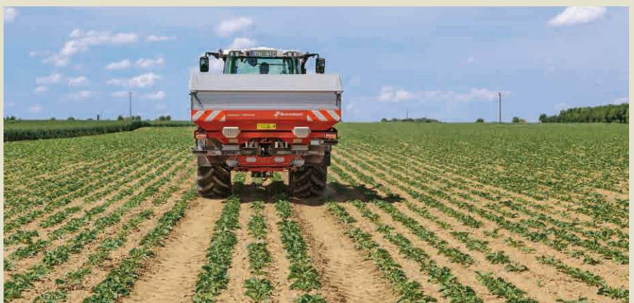
Grenzstreuen unter Verwendung des ExactLine Systems
