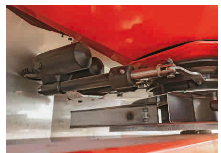
Zwei Stellmotoren an jedem Dosiersystem steuern den Aufgabepunkt und die Dosiermenge
