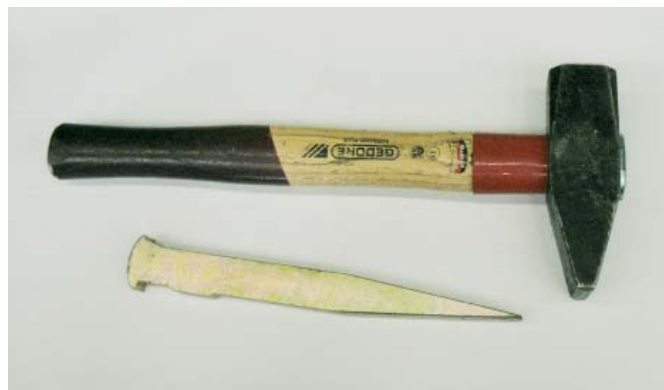
Bild 9: Werkzeug für den Scharwechsel
