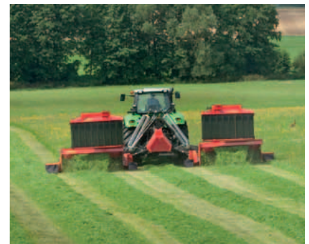
Wenn die Schwadverlegebänder nicht in Gebrauch sind, werden sie einfach hydraulisch nach oben geschwenkt.
