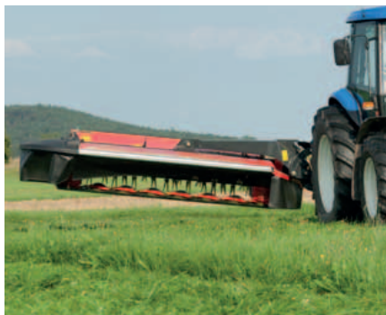
Hohe Aushubhöhe am Vorgewende.
