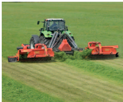
Das Schwadablegeband schafft es, Arbeitsbreiten von 9,00 m oder 6,00 m in ein Schwad zu legen.
