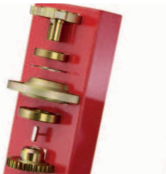
Wirkungsvoller Schutz: Bei Überlast schert ein kleiner Metallstift ab, sodass Zahnräder und Antriebsstrang nicht beschädigt werden.
