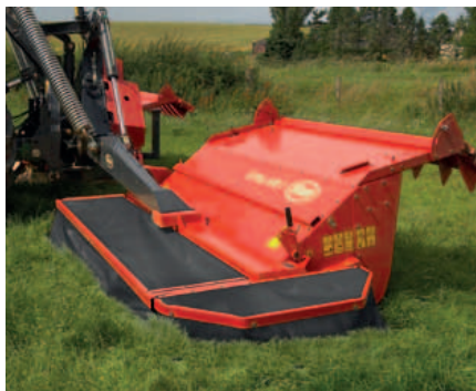
Die mittige Aufhängung der beiden hinteren Mäheinheiten sorgt für hervorragende Boden Anpassung.
