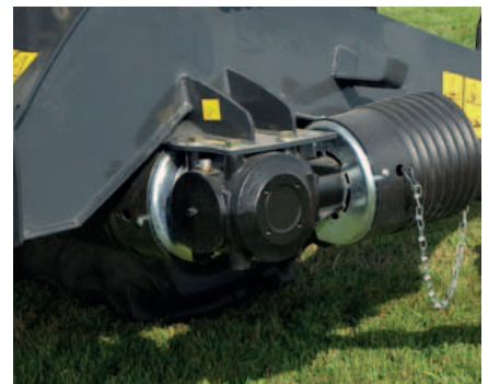
Die Zapfwellengeschwindigkeit kann durch Drehen des Getriebes von 540 auf 1000 U/min geändert werden.
