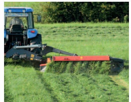
Schnelle Umstellung von Schwadablage auf Breitablage.
