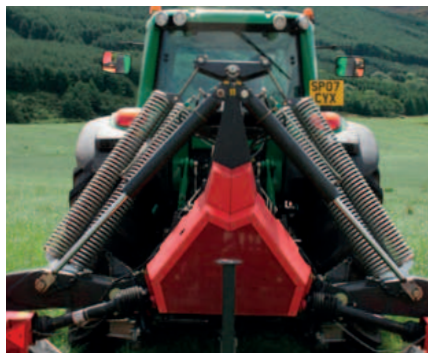
Vier groß dimensionierte Entlastungsfedern sichern gleichmäßige Federung und Schnitthöhe.
