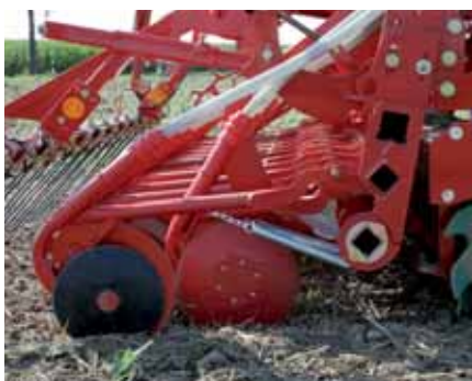
Hydraulische Scharschienenaushebung: Falls die Kreiselegge solo genutzt werden soll, wird die Scharschiene einfach ausgehoben. Dabei wird das Spornrad automatisch außer Eingriff positioniert, so dass der Dosierantrieb unterbrochen ist.
