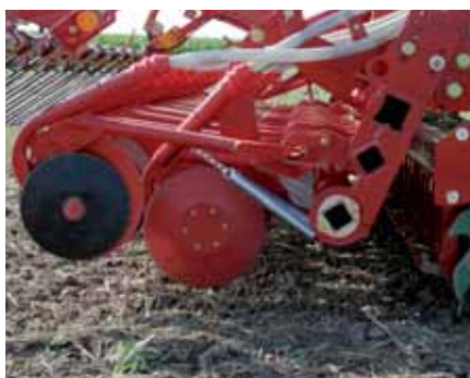
Hydraulische Scharschienenaushebung: Falls die Kreiselegge solo genutzt werden soll, wird die Scharschiene einfach ausgehoben. Dabei wird das Spornrad automatisch außer Eingriff positioniert, so dass der Dosierantrieb unterbrochen ist.
