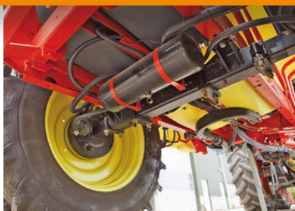
Verstellachse für 40 km/h
