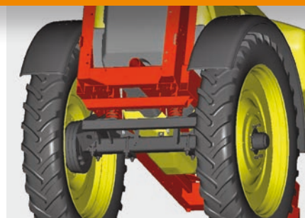
Gefederte Verstellachse für 40 km/h
