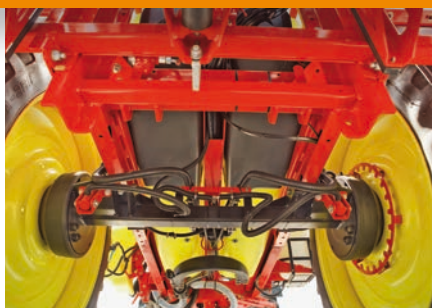
Starre Achse für 25 km/h
