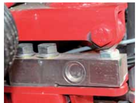
Wiegestäbe unter dem Düngertank präzisieren die Ausbringung.
