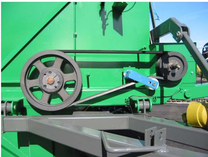
BILD : Keilriemeneinstellmutter für die Hebetrommel
