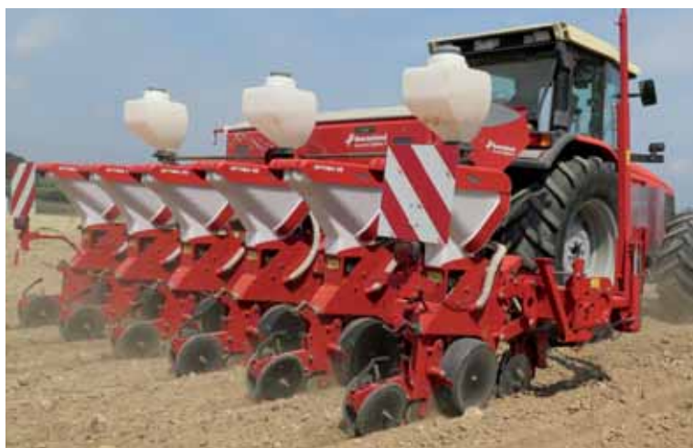
OPTIMA V e-drive II: 6 Reihen variabel teleskopierbar, 4,5 m Arbeitsbreite, 1000 l Düngerkapazität
