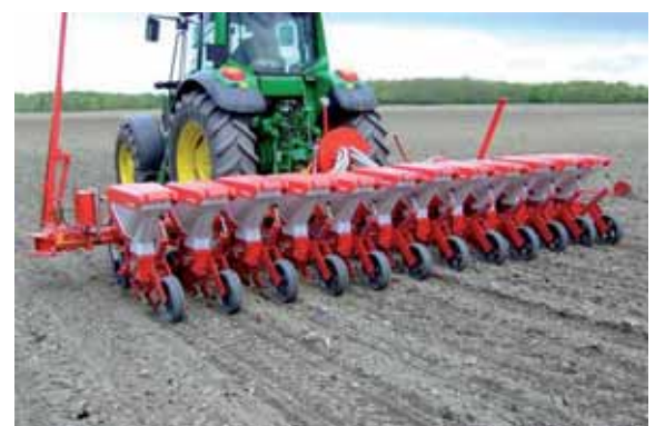
6 m starrer Rahmen mit 12 Reihen und 45 cm Reihenabstand
