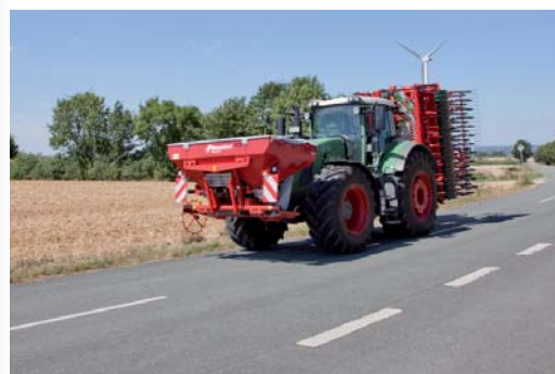
Klappbar auf 3,0 m Transportbreite für sicheren Straßen- transport
