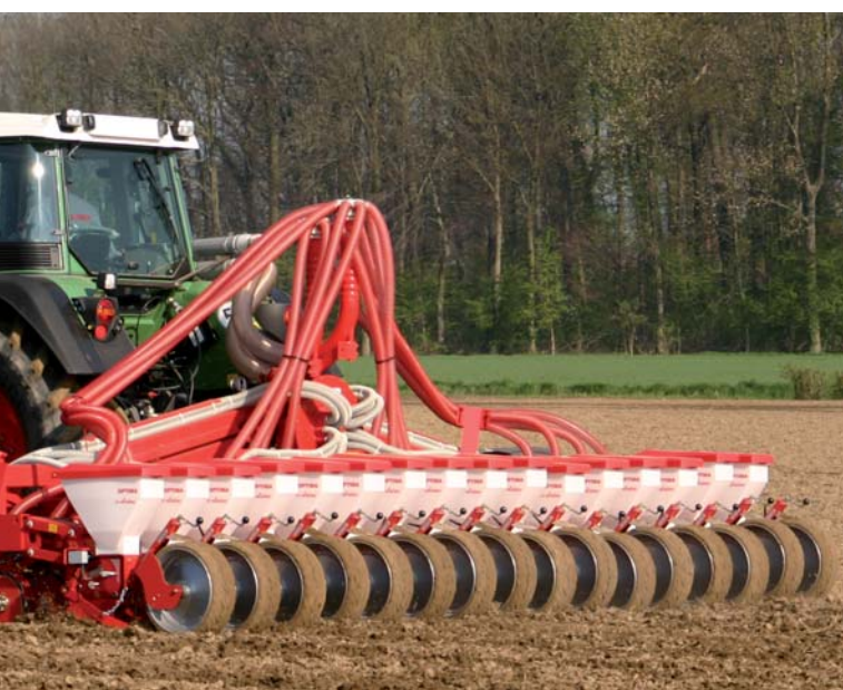
In Kombination mit einer Einzelkornsämaschine kann der Fronttank DF-2 zur Reihendüngung (bis zu 16 Reihen) eingesetzt werden
