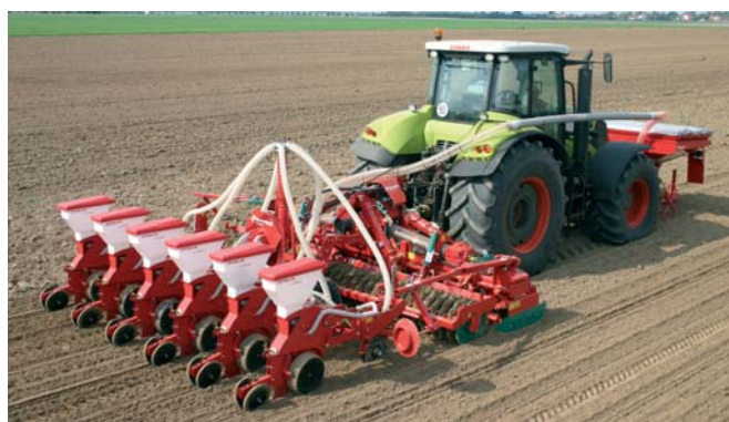
Der DF-1 Tank als Düngerbehälter bei der Einzelkornsaat bis zu 8 Reihen
