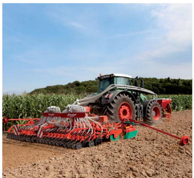
Optimale Saatschlauchführung sorgt für sichere Saatgutverteilung.
