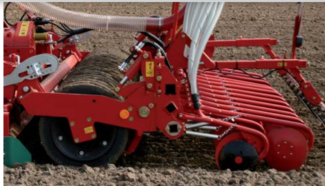
Direkte Verbindung zum Walzenrahmen und zur Scharschienaushebung (Option)
