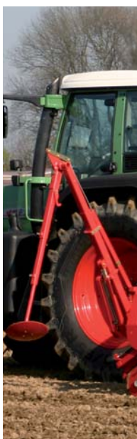
Der hydraulisch klappbaren Spuranreißer mit Überlastsicherung befinden sich direkt auf der Wanne der Kreiselegge.
