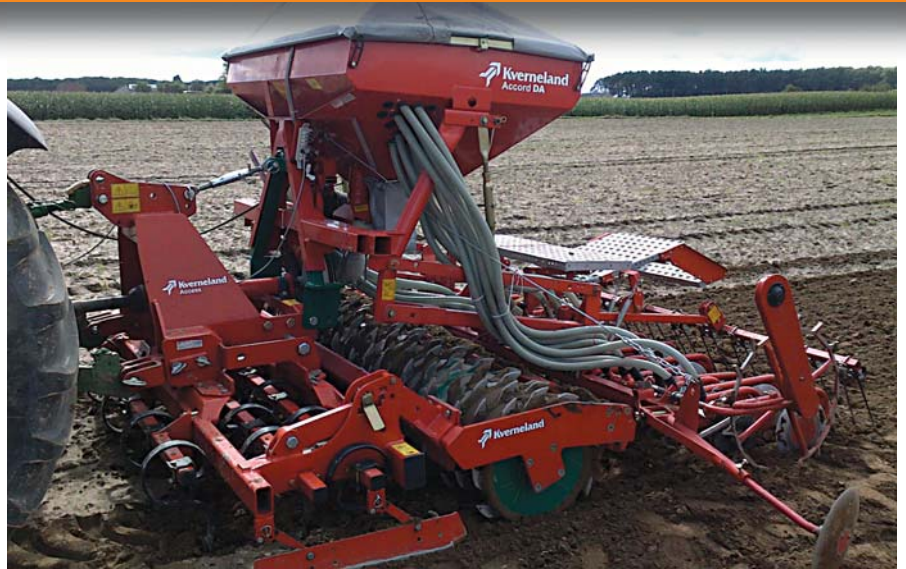
DA 3,0 m in Kombination mit Saatbettkombination Access
