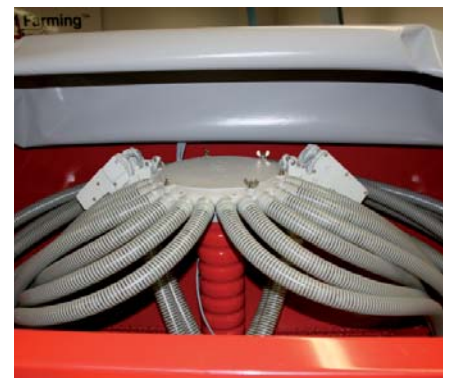
Im Tank liegender Verteilerkopf
