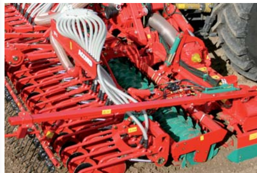
Der hydraulisch klappbaren Spuranreißer mit Überlastsicherung befinden sich direkt auf der Wanne der Kreiselegge.
