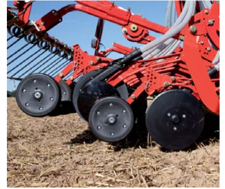
Soll die Kreiselegge während des Säens solo eingesetzt werden, kann die Scharschiene samt Spornrad über die beiden integrierten Hydraulikzylinder komplett ausgehoben werden. Dies ist insbesondere dann von Vorteil, wenn Furchen geschlossen oder das Vorgehende nur gekreist werden soll.
