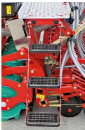
Sicherer Zugang durch große Beladestufen und einer massiven Plattform.
