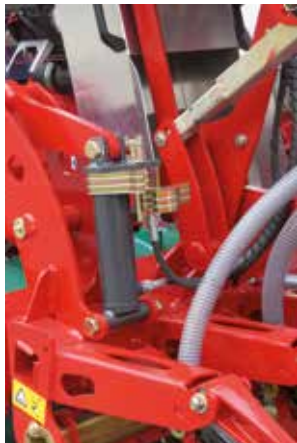
Die zentrale Sätiefeneinstellung mittels Spacer befindet sich an den zwei außen positionierten Hydraulikzylindern.
