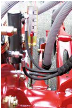
Die Skala der Schardruckverstellung kann auch während der Fahrt vom Fahrer abgelesen werden.
