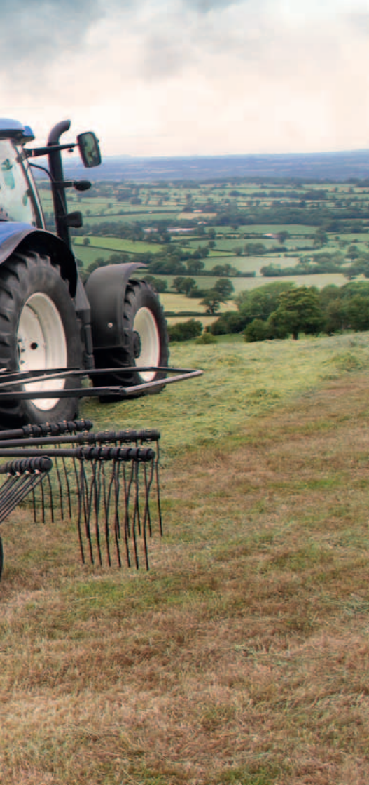
Mit 9.00 m Arbeitsbreite und einer Transporthöhe unter 4.00 m. Ohne die Zinkenarme zu demontieren...
