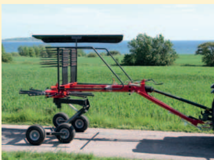
Mit der Ackerschienenanhangung können die Index 424T und Index 474T mit sehr kleinen Traktoren eingesetzt werden.
