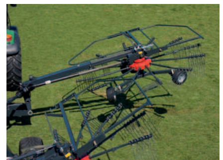
Hydraulisch einstellbare Arbeitsbreite von 10,00-12,50 m.
