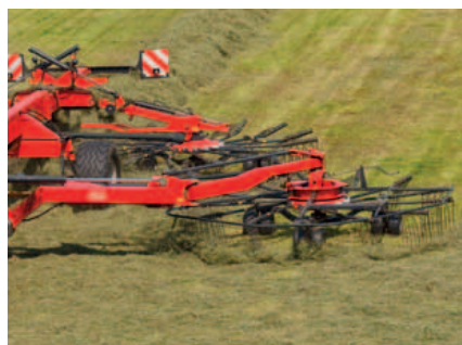
Die Arbeitsbreite lässt sich in einem Bereich von 9,50 bis 15,00 m hydraulisch einstellen.
