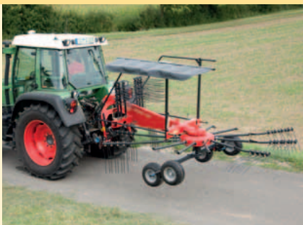
Um die Transport-/Unterstellbreite zu reduzieren, lassen sich bei allen Einkreiselschwadern die Zinkenarme abnehmen und die Schutzbügel nach oben klappen.
