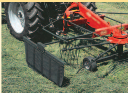
Index 353 besitzt eine Arbeitsbreite von 3,50 m und 10 abnehmbare Zinkenarme.
