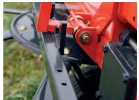
Die Grenzstreueinrichtung wird zentral von Schleppersitz eingestellt.
