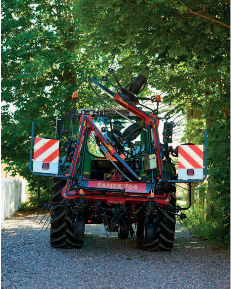
Kompakt während des Transports und Lagerung, dank des neuen cleveren Klappungsmechanismus.
