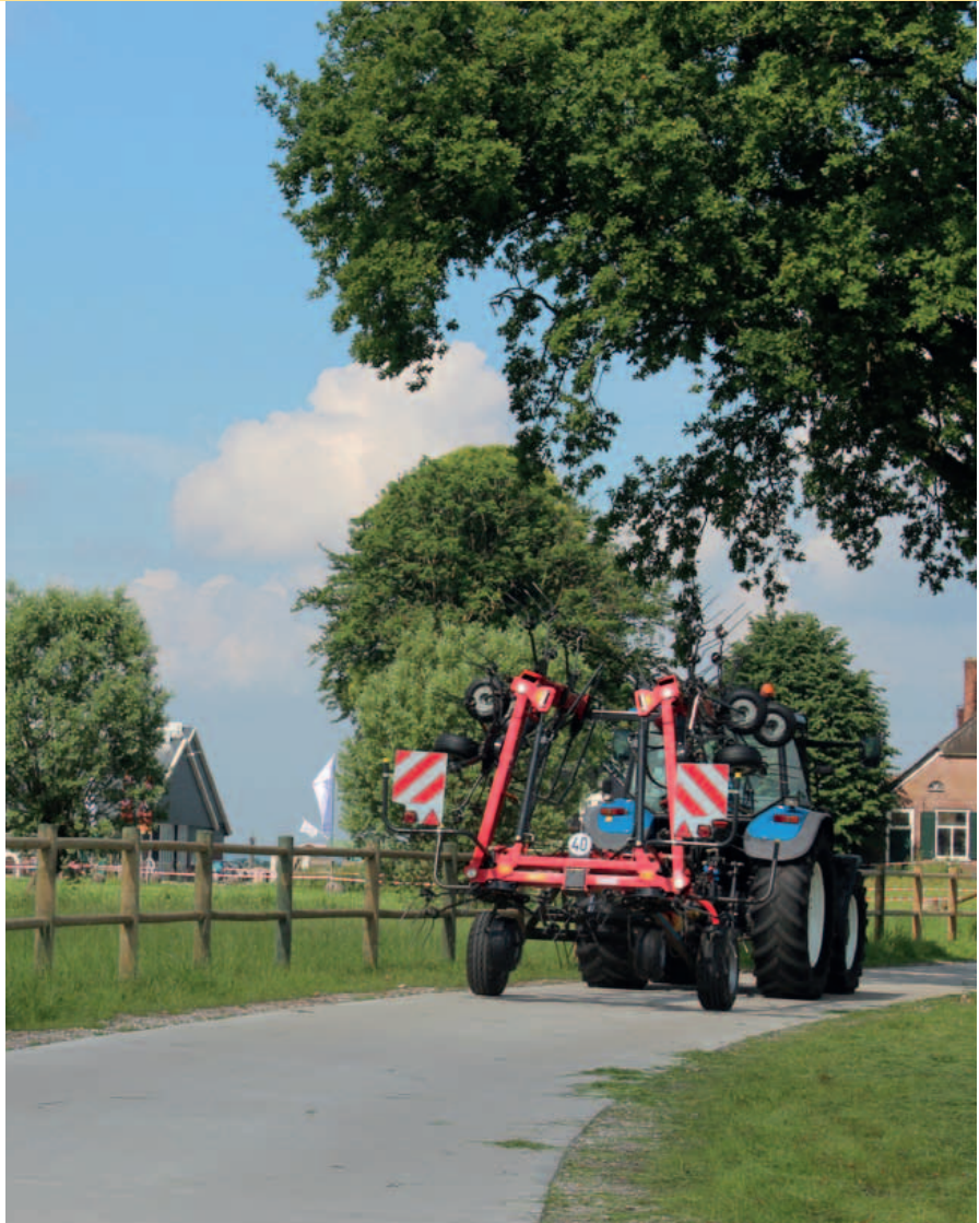
Während des Transports erreicht der Wender eine Transporthöhe von weniger als 3,40 m sowie eine Transportbreite von unter 3,00 m.
