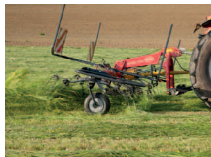
Die Schwingungsdämpfer sorgen für ein gleichmäßiges Streubild.
