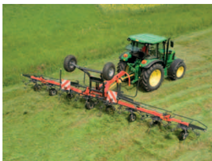
Für das Grenzstreuen wird die ganze Maschine schräg gestellt. Die Einstellung erfolgt mechanisch aus der Schlepperkabine. Eine hydraulische Verstellung ist optional erhältlich.
