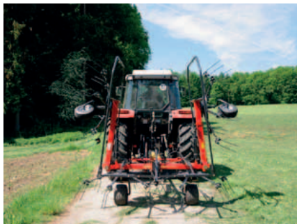
Während der hydraulischen Klappung, für den Transport, werden die Zinken automatisch angehoben.
