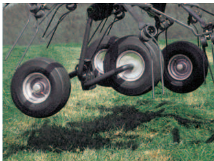
Die auf Wunsch lieferbaren Tandemachsen verbessern die Boden Anpassung und erhöhen die Laufruhe für die Modelle Fanex 464 und Fanex 524.
