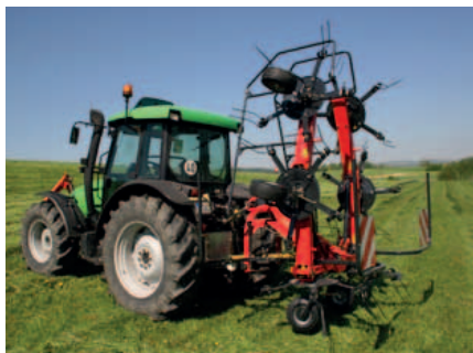
Der Kreiselzettwender Fanex 604 wird hydraulisch von Arbeits- in Transportposition und umgekehrt geklappt.
