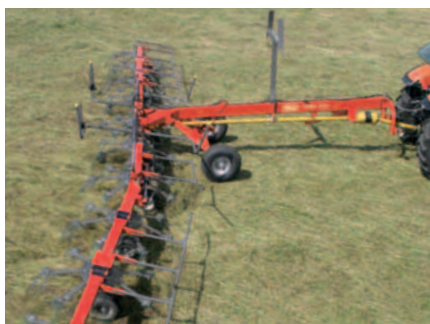
Die drei äußeren Kreisel auf der rechten Seite werden über einen Hydraulikzylinder zum Grenzstreuen verstellt.
