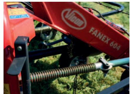
Die Schwingungsdämpfer gewährleisten ein gleichmäßiges Streubild.
