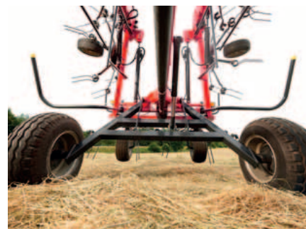
Breite Transportachse für sicheren Straßentransport.
