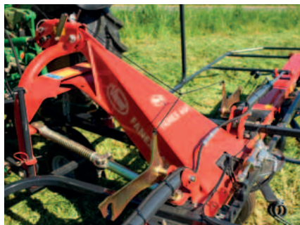
Die robuste Konstruktion des V-förmigen Hauptrahmens sorgt während des Zettens für eine hohe Stabilität und erlaubt eine hohe Transportgeschwindigkeit.
