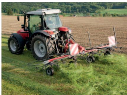
Durch das Grenzsetzen bleibt das Erntegut innerhalb des Feldes.
