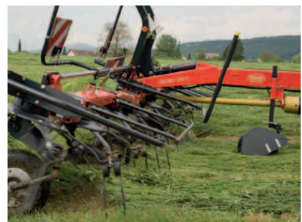
Optional können die Zettwender mit einem Stützrad ausgerüstet werden. Die gewünschte Arbeitshöhe ist werkzeuglos einstellbar.
