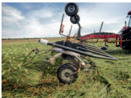
In Arbeitsstellung ruht das Gewicht des Tragerahmens auf dem zentralen Teil der Maschine.
