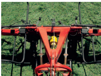
Die starke Konstruktion des Mittelrahmens bietet hohe Stabilität während des Einsatzes und erlaubt eine hohe Transportgeschwindigkeit.
