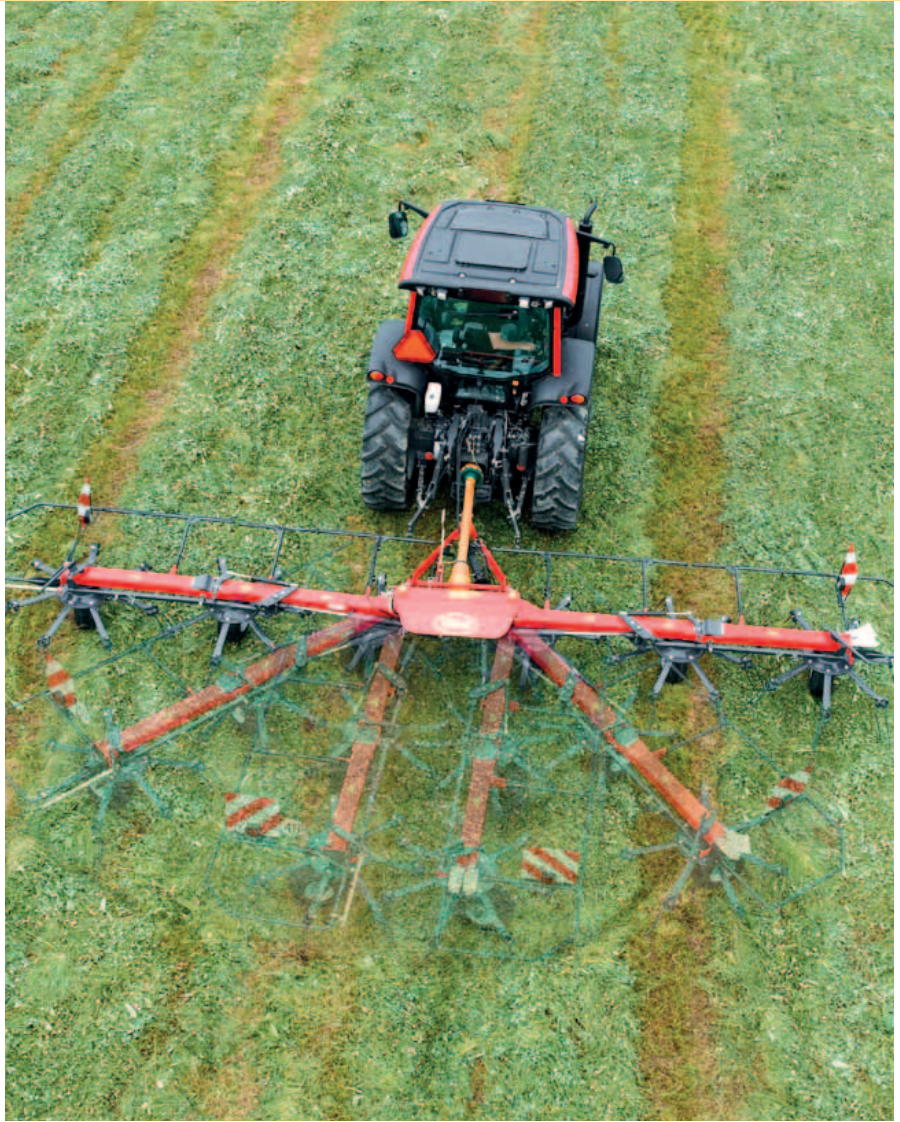
Die Umstellung von Transport- in Arbeitsstellung ist bequem aus der Schlepperkabine durchzuführen.
