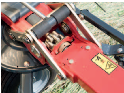
HexaLink-Fingerkupplung erlaubt es, die Kreisel um 180° für den Transport zu klappen.
