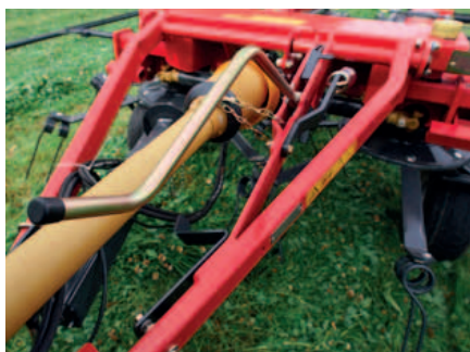
Einfache Einstellung der Rotorhöhe durch einen Handgriff.
