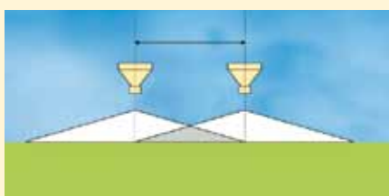
Das pyramidenförmige Streubild mit vollständiger Überlappung
