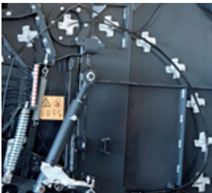
Alle Walzenlager können leicht über zentrale Schmierleisten abgeschmiert werden.
