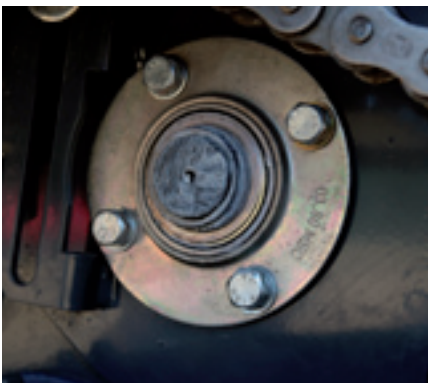
Jede Walze ist in Heavy Duty-Lagern montiert.
