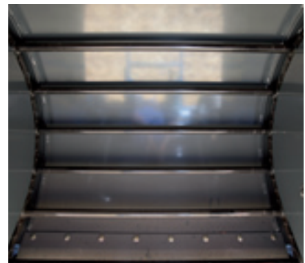
...und einem Stabkettenelevator in der Heckklappe.
