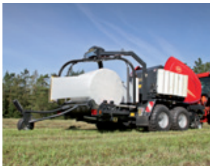
Doppelter Satellitenwickler mit 2 Vorstreckern und 4 Endlosriemen für ein schnelles und stabiles Wickeln.
