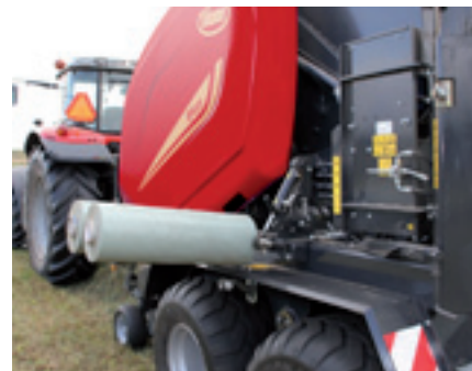
Ersatzrollen mit hydraulischer Bedienung für maximalen Bedienkomfort.
