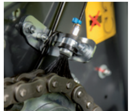
Automatische Kettenschmierung ist serienmäßig.
