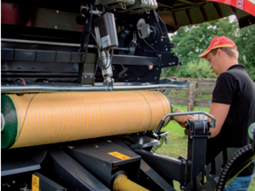
Die sehr niedrige Ladehöhe und das leichte Einlegen der Netzrolle bedeuten minimale Standzeiten zum Netzwechsel und mehr produktive Zeit zum Pressen.
