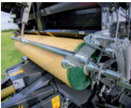
Neue effiziente PowerBind-Netzbindung.
