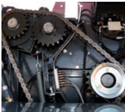
Eine Heavy Duty 1¼ Zoll Antriebskette sorgt für hohe Einsatzsicherheit und niedrige Wartungskosten.
