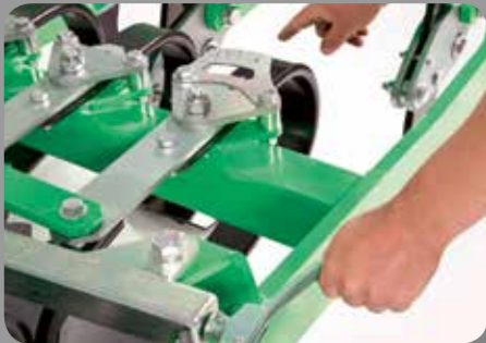
EINFACHE SCHEIBENWINKELVERSTELLUNG – Durch die benutzerfreundliche stufenlose Einstellung der Scheibenwinkel können Sie die Intensität der Bodenbearbeitung festlegen. Mit einem spitzen Winkel erzielen Sie einen höchst effizienten Stoppelsturz in einem Arbeitsgang, ein flacherer Winkel dagegen ist beim Unterpflügen hilfreich.
